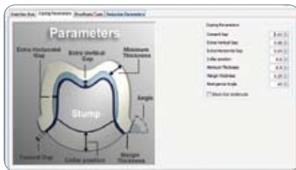
Fig.2 Editing coping parameters
